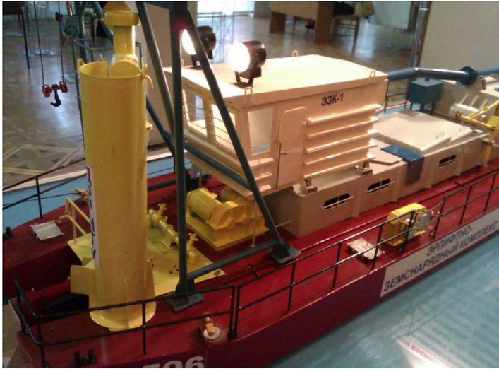
Действующий макет эрлифтно-земснарядного комплекса по гидродобыче песка со дна внутренних водоёмов
