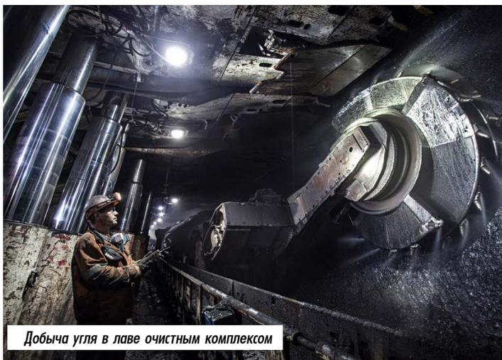
Добыча угля в лаве очистным комплексом
